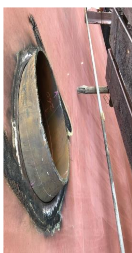
排外貫穿管外板外貌，該外板須上需要特殊防酸時處理。
